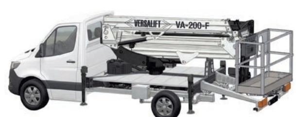
Versalift stellt die V-Range vor, eine neue 3,5-Tonnen Baureihe, die eine Lücke im europäischen Markt für Lkw-montierte Hubarbeitsbühnen schließen soll.
