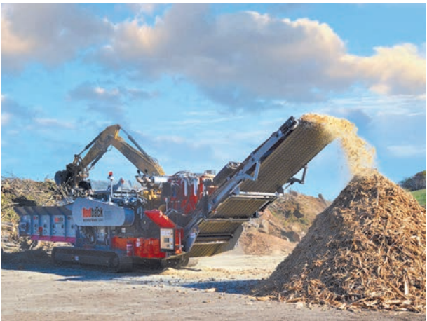
Der schnelllaufende Zerkleinerer ist mit einem CAT C32-Dieselmotor ausgestattet, der mit 1125 PS für maximalen Durchsatz sorgt.
