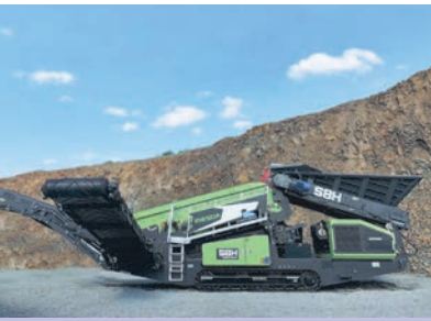
Die mobile Siebanlage MESDA S8H kombiniert Stage-V-konforme Dieselmotor mit einer externen elektrischen Betriebsart.
