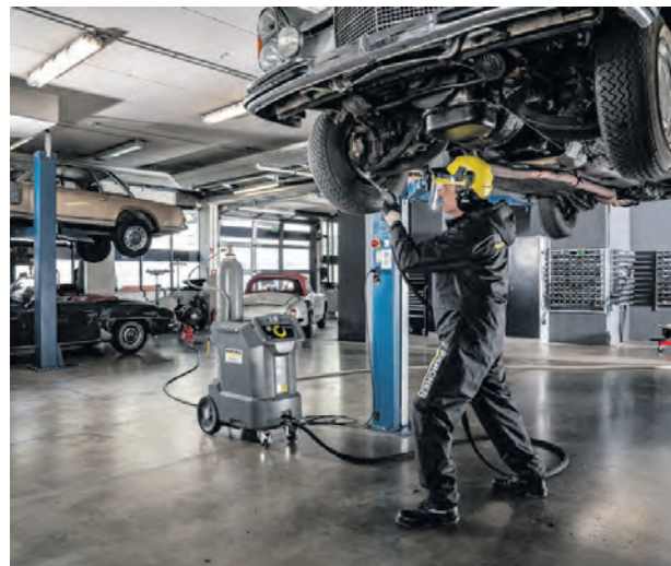
Die neuen Zubehöre sollen die Arbeit mit dem Trockeneisstrahlgerät IB 10/15 L2P Advanced in Werkstätten und Produktionsbetrieben erleichtern.
