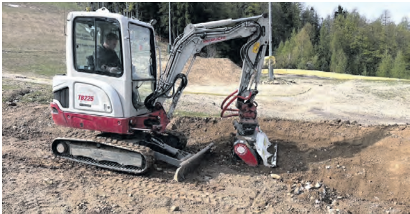
Durch die Ausrüstung mit dem PTH Excavator Crusher EC-S transformiert sich der vorhandene Minibagger in eine kompakte Arbeitsmaschine.
