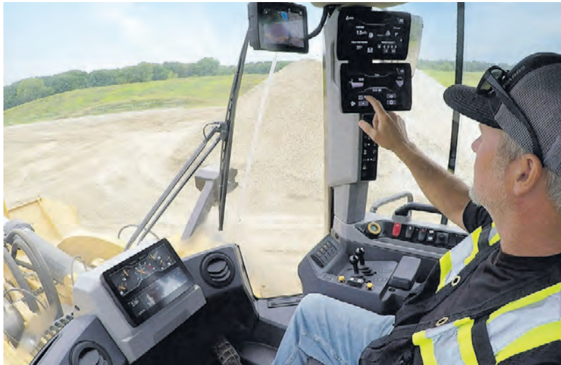
Der Fahrer kann genau dokumentieren, wie viele Tonnen Splitt, Kies oder andere Materialien verladen und abtransportiert wurden.
