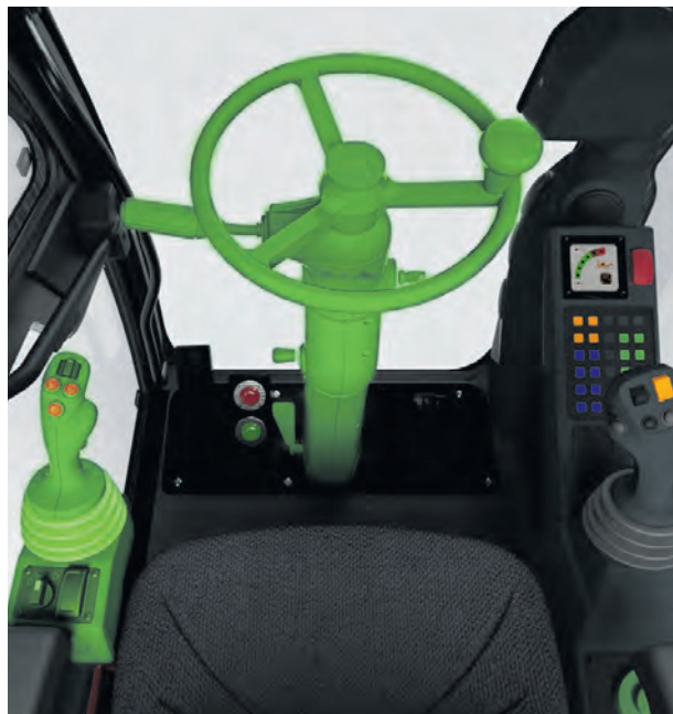
Die Kombination aus klassischem Lenkrad und zusätzlicher Joysticklenkung bietet hohe Flexibilität, da der Fahrer zwischen präzisiertem Rangierbetrieb und stabilem Fahrverhalten wählen kann.
