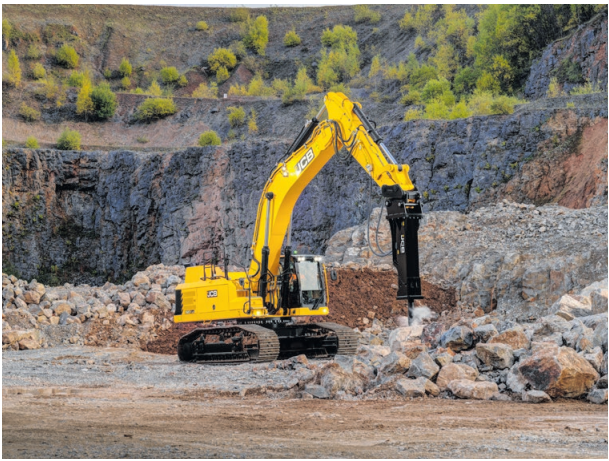
Zur Sicherheitsausstattung zählen eine ROPS-zertifizierte Kabine, das hydraulische Abschaltsystem JCB-2-Go sowie eine serienmäßige 360-Grad-Kamera.
