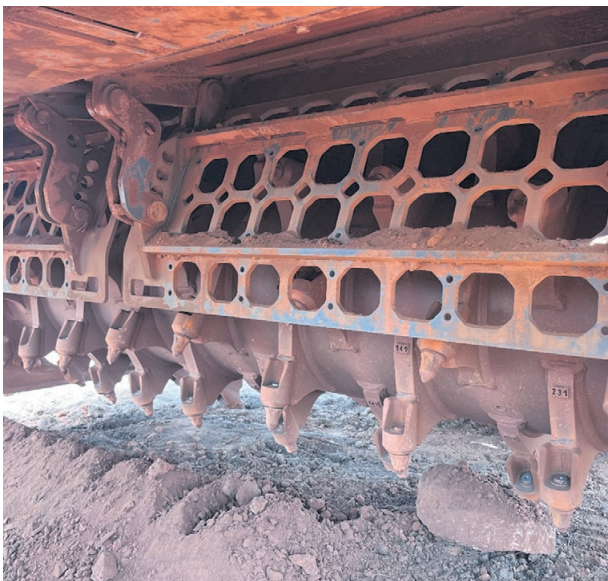
Das Herzstück des Vario Impact Sizer ist ein geteiltes Prallblech, das direkt am Schneidwalzengehäuse montiert ist.
