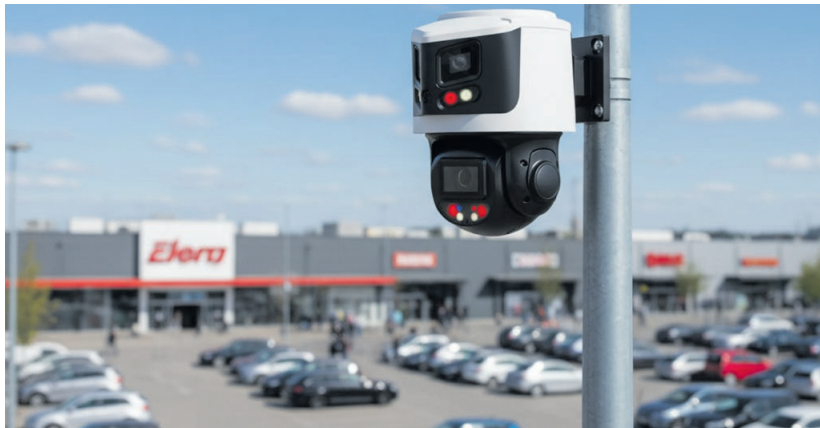
Das KI-basierte Flächenmonitoring von Wemolo erkennt auf Park- und Außenflächen automatisch Vandalismus und erstellt sofort Tickets mit Bildnachweis.
