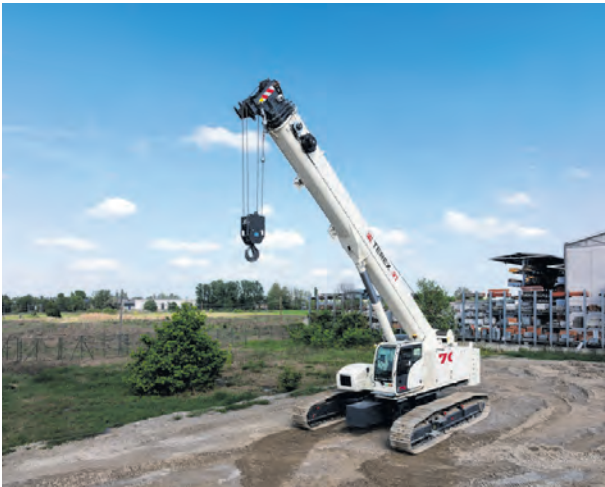
Der TTC 70 verfügt laut Hersteller über eine maximale Tragfähigkeit von 70 t.
