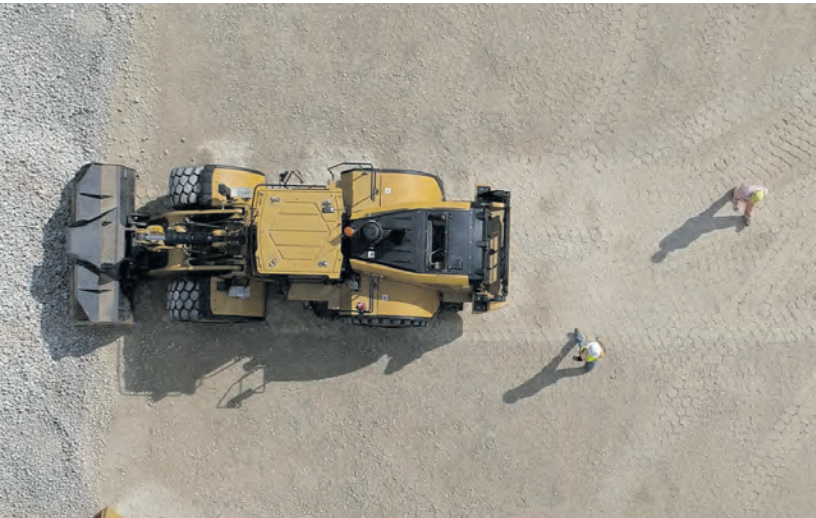
Die Personenerkennung erfasst Menschen im hinteren Arbeitsbereich und markiert diese direkt im Fahrerdisplay.
