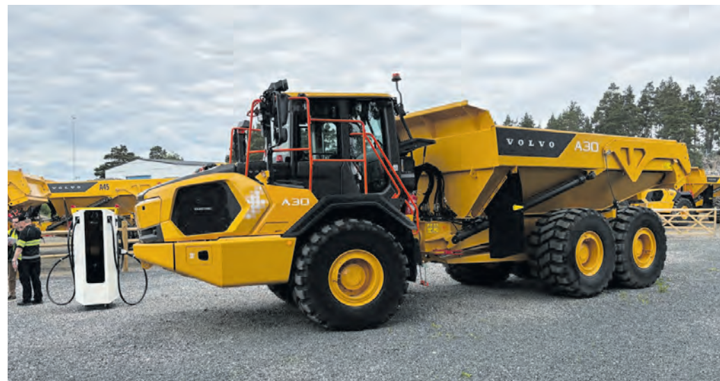
Die Muldenkipper A30 Electric und A40 Electric von Volvo CE gehen als weltweit erste batterieelektrisch angetriebene knickgelenkte Dumper ihrer Größenklasse in Serie.
