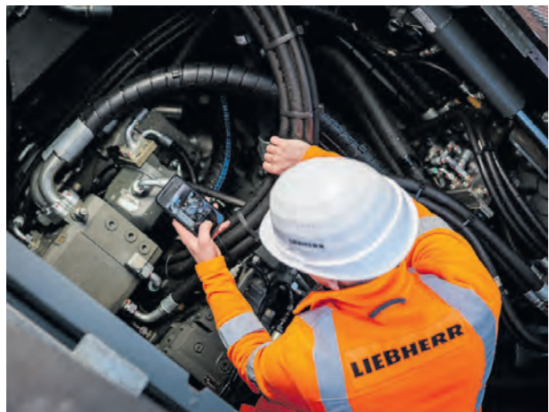
Mit dem Parts-Assistant-App lassen sich Teile über ein Foto direkt an der Maschine identifizieren.
