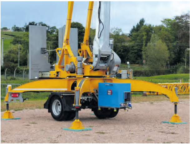
Die Batterie kann laut Hersteller bei einer Stromversorgung von 16 A innerhalb von 2 Stunden und 15 Minuten von 50 auf 85 % ihrer Kapazität geladen werden.
