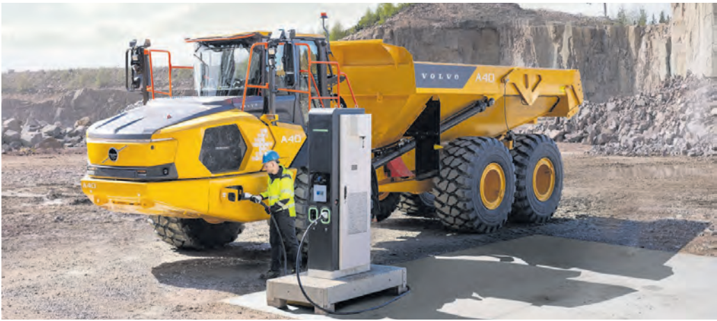
Mit Nutzlasten von 29 und 39 Tonnen zählen der A30 Electric und der A40 Electric zu den größten Maschinen im E-Portfolio von Volvo CE.
