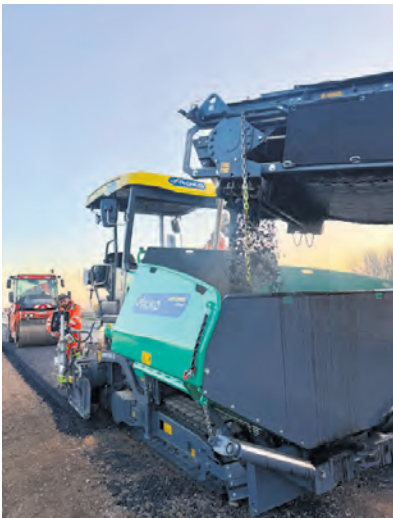
Die von Rüko entwickelte vordere Bunkerwand vergrößert das Fassungsvermögen des Materialbunkers und ermöglicht die Beschickung über einen Beschicker.
