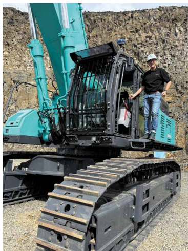
Hanns Markus Renz Kobelco präsentierte den SK850LC-11. Der größte konventionelle Kobelco-Kettenbagger in Europa bringt je nach Ausrüstung bis zu 87 Tonnen auf die Waage. Sein 382 Kilowatt starker Isuzu-Motor ermöglicht eine Losbrechkraft von bis zu 432 Kilonewton. Zur Serienausstattung gehört die Echtzeitverriegung K-Load.
