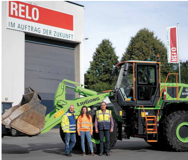
Der elektrische Antrieb des 856HE arbeitet nach Angaben der Beteiligten deutlich leiser als ein vergleichbarer Dieselantrieb.
