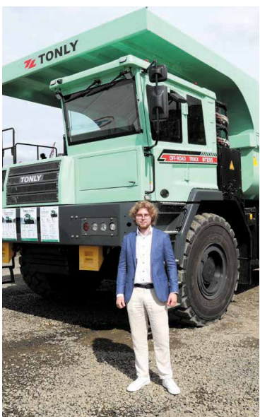
Der in Polen ansässige Händler Kuno-va präsentierte zur steinexpo einen dreiachsigen voll elektrischen Kipper des chinesischen Herstellers Tonly für den Offroad-Einsatz. Das Fahrzeug bietet einen Traglast von 50 Tonnen, seine Batterien verfügen über eine Leistungskapazität von 801 kW. Laut Cristiano Delgado , Sales Director in Europa von Tonly, soll die Leistungsfähigkeit des vollelektrischen Kippers T95 für eine komplette Tages-Arbeitsschicht ausreichen, dessen Batterien, ließen sich innerhalb von eineinhalb Stunden über eine Schnellladung wieder komplett aufladen. Kuno-va führe insgesamt zwölf Kipper verschiedener Leistungsklassen im Programm. Das Unternehmen ist erstmals auf der steinexpo vertreten.
