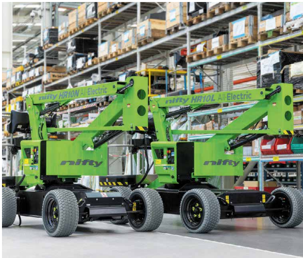
Die neue HR10 in zwei Ausführungen: die schmale HR10NE (links) und die gewichtsreduzierte HR10LE (rechts). Beide Maschinen sind Prototypen.
