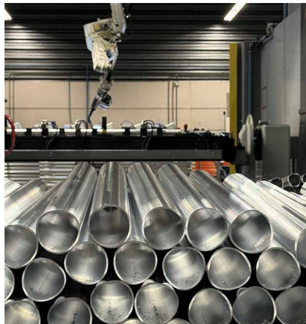
Aluminiumprofile werden bearbeitet und zu den unterschiedlichen Komponenten eines Fahrgerüsts weiterverarbeitet.
