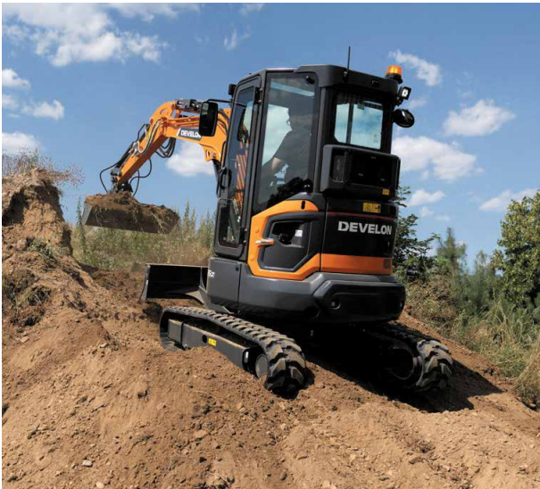
Leistungsstark: Der DEVELON DW01-Dieselmotor des DX35Z-7 mit 18,4 kW (25 PS) bietet die erforderliche Kraft für anspruchsvolle Einsätze.
